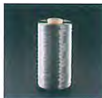
東しの炭素繊維は航空機やシエールガスを運搬する圧力容器など幅広い分野で採用されています。
