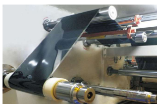
積水化学のフィルム型ペロブス電池は印刷用輪転機のように大量生産が可能
